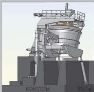
наклон в сторону рабочего окна для скачивания шлака
