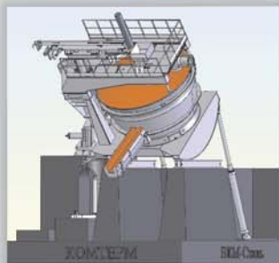
наклон печи для полного слива металла
